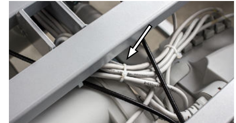
Position des Kabelbinders über dem fußseitigen Liegeflächenmotor.
