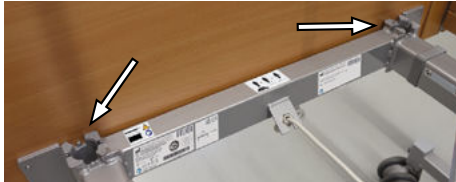
Aufrichteraufnahmen \varnothing 34,2 mm
